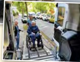
eine Rampe in den Wagen fahren und während der Fahrt im Rollstuhl sitzen bleiben. Um die Verkehrssicherheit zu gewährleisten wird der Rollstuhl hierfür an speziellen Halterungen im Fahrzeug befestigt.
