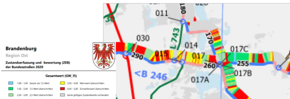
Abb. 26 Zustandserfassung und –bewertung der Bundesstraßen, 2020 Quelle: Landesbetrieb Straßenwesen Brandenburg, 2020
